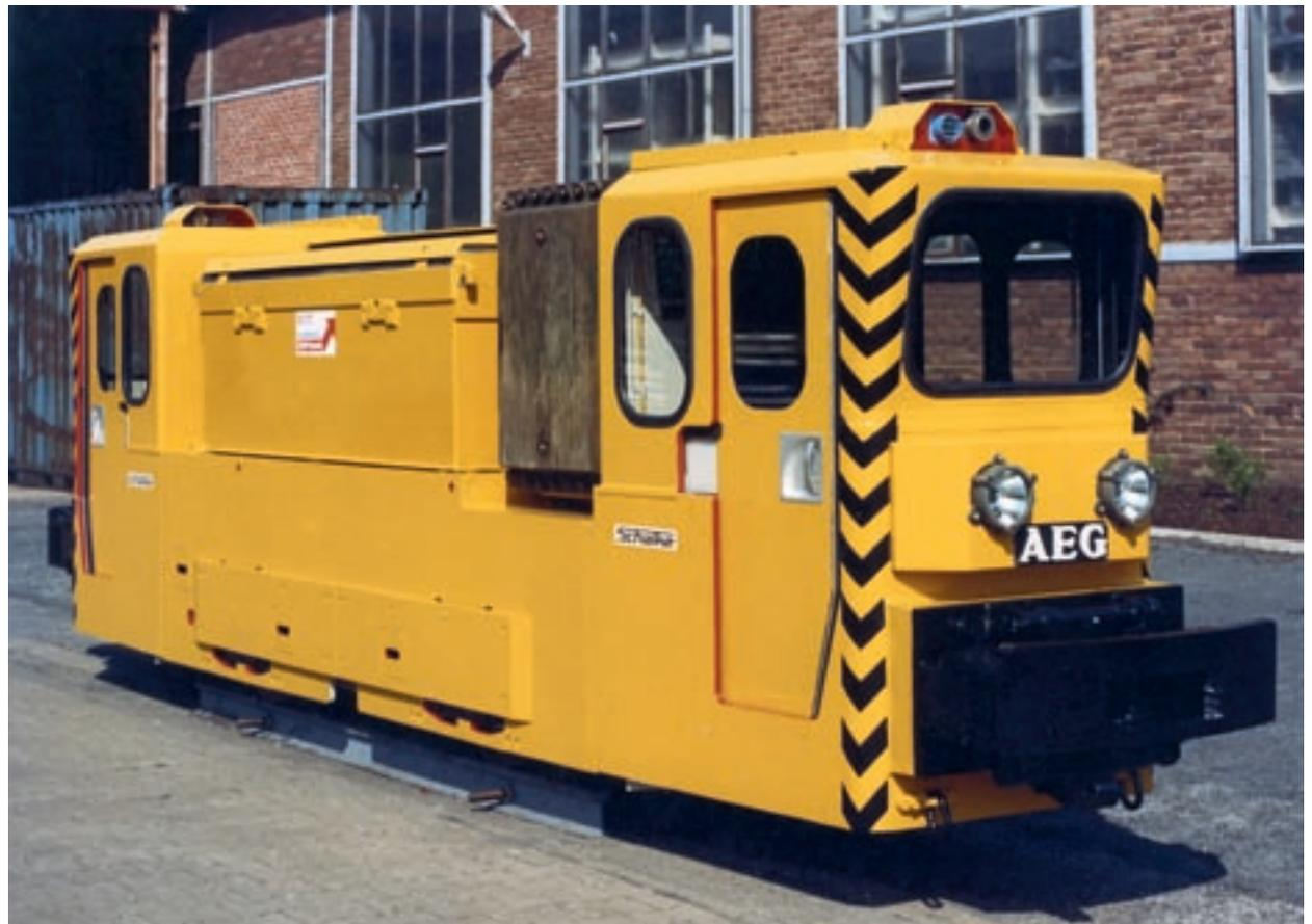
183 Nach der Übernahme von Bartz ist die Schalker Eisenhütte auch für die AEG im Grubenlokbau ein fester Partner. Zwei dieser modernen GA13b-Akkuloks – AEG Type HA4ö – mit Federspeicherbremse werden 1984 für die Grube **Reden** im Saarland gebaut; Schalke 2.338–2.339/AEG 9.040–9.041.
