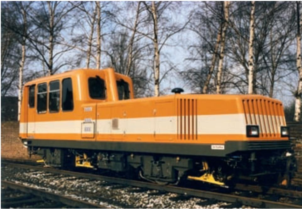
224 Große Kabine, langer Maschinenvorbau: Das äußere Erscheinungsbild des Gleismesstriebwagens für die **Hamburger Hochbahn** ist nicht eben preisverdächtig, aber zweckmäßig. Die gelben, ankerförmigen Bauteile vor und hinter den Achsen sind die Gleismess-Schlitten.
