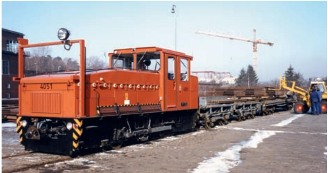
net. Entlang des langen Vorbaus gab es seitlich abklappbare Trittröste. Für Nacht- und Tunneleinsätze konnten auf einem speziellen Halbebügel vorne große Scheinwerfer montiert werden. Die Fahrzeug-Umgrenzungen machten Einsätze im Klein- wie im Großprofil der Berliner U-Bahn möglich.
