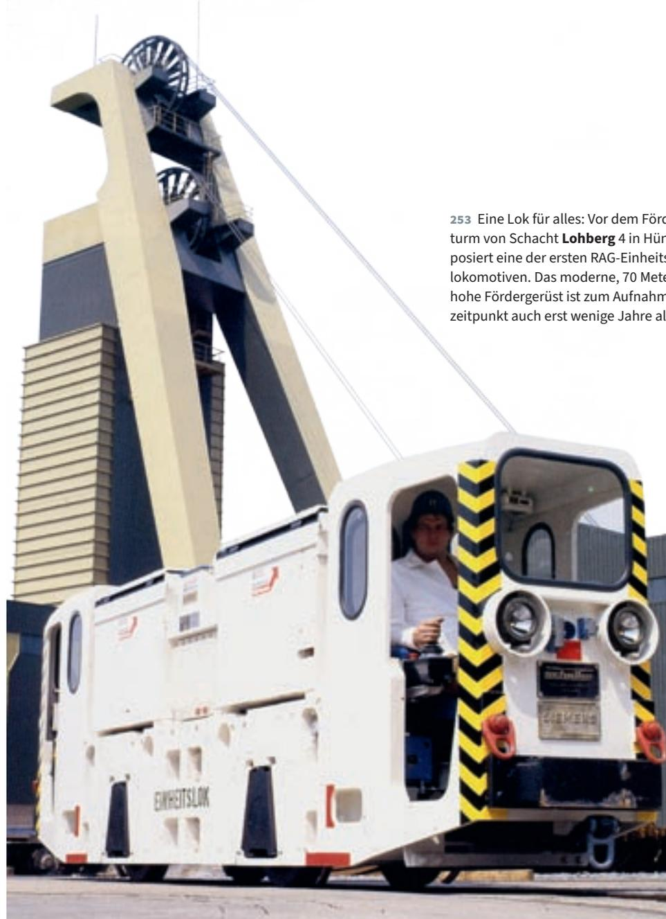
253 Eine Lok für alles: Vor dem Förder-turm von Schacht **Lohberg 4** in Hünxe posiert eine der ersten RAG-Einheitslokomotiven. Das moderne, 70 Meter hohe Fördergerüst ist zum Aufnahmezeitpunkt auch erst wenige Jahre alt.
