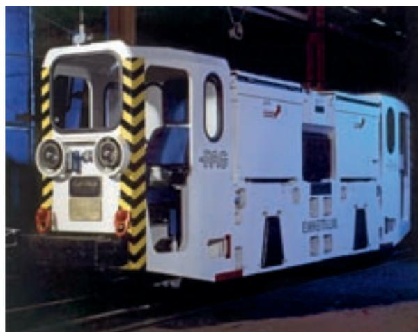
4 Moderne Technik untertage: Die ab 1992 gebauten Ruhrkohle-Einheitsloks hatten Drehstrommotoren und eine sehr innovative Baukasten-Konstruktion. Die erste sogenannte REL A ging an die **Zeche Lohberg** in Dinslaken.
