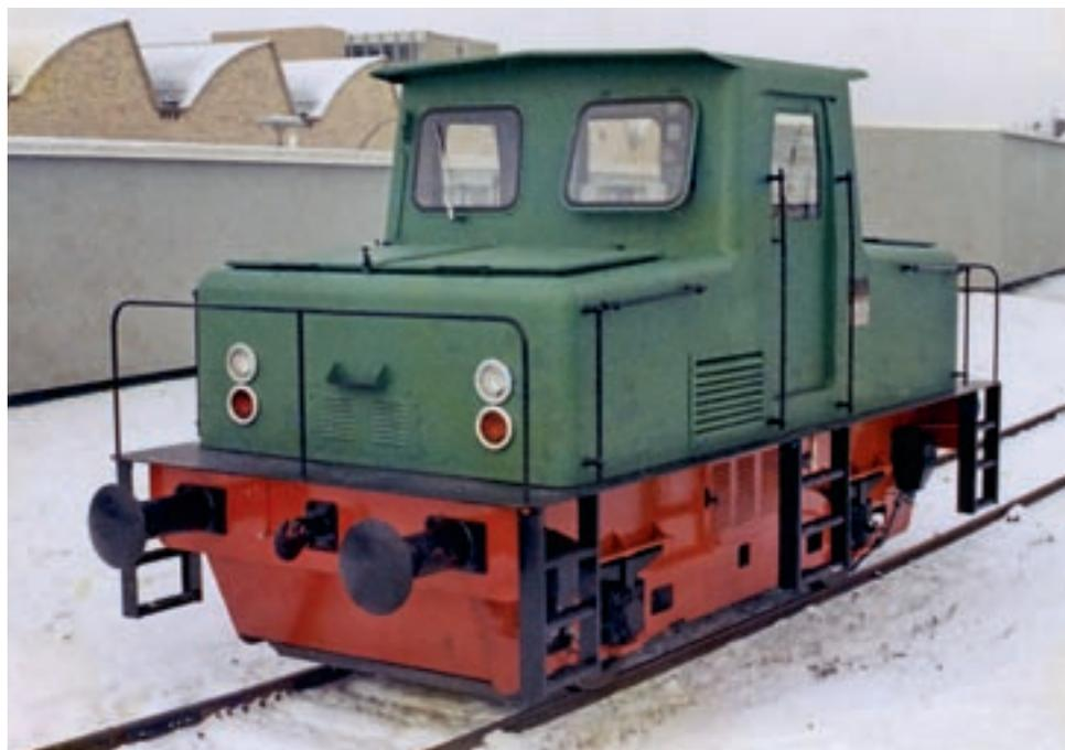
Zu beiden Loks ist nicht so ganz viel zu sagen: klassische Mittelführerstandslokomotiven mit Batteriekästen in den Vorbauten davor und dahinter, mittlere Leistung, große Achsstände. Die WWT-Lok hat Gleichstromsteller-Steuerung mit Nutzbremse, also Rückspeisung der Bremsenergie in die Batterien.
