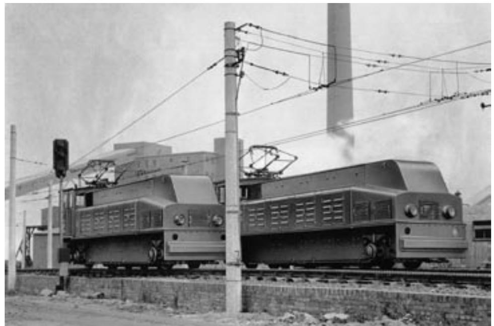
51 Diese sonderbaren Zahnrad-Abraumloks sollen ebenfalls bei Schalke gebaut werden. Der Auftrag geht letztlich aber an Krauss-Maffei.
