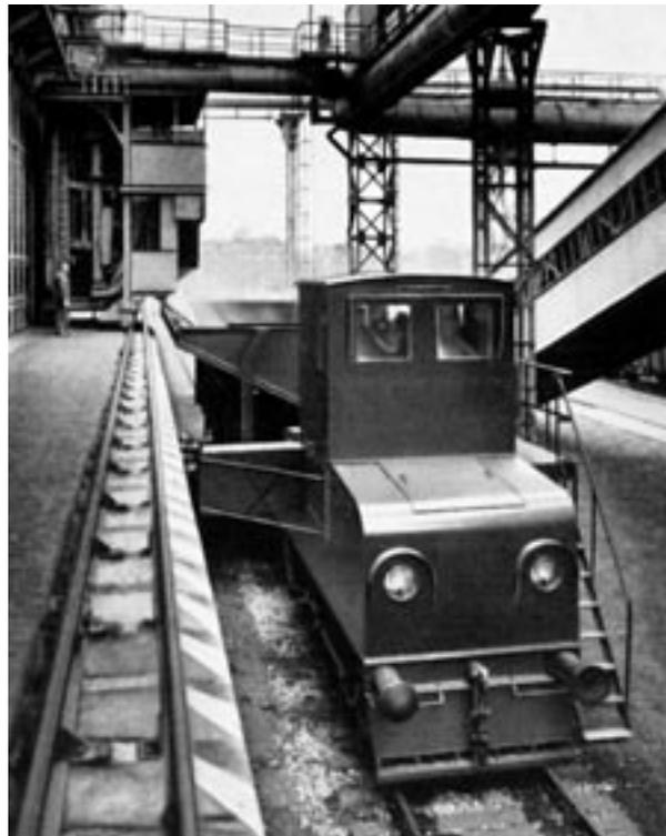
**114** Keine Experimente: Die 50er-Jahre-Kokslöschloks der Bauart BBC sehen mit ihrem Blindwelle- und Stangen-Antrieb noch genauso aus wie die BBC-Vorkriegsloks, hier die Ausführung für die **Kokerei Dorstfeld** in Dortmund.
