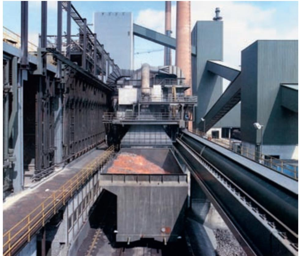
Leitsysteme, ebenfalls von Schalke entwickelt, ermöglichen es dabei, Lok und Löschwagen automatisch immer exakt vor der jeweils zu öffnenden Ofentür an der Löschrampe zu positionieren und den Löschwagen beim Koksdrücken in der genau richtigen Geschwindigkeit für eine gleichmäßige Beladung zu verschieben.
