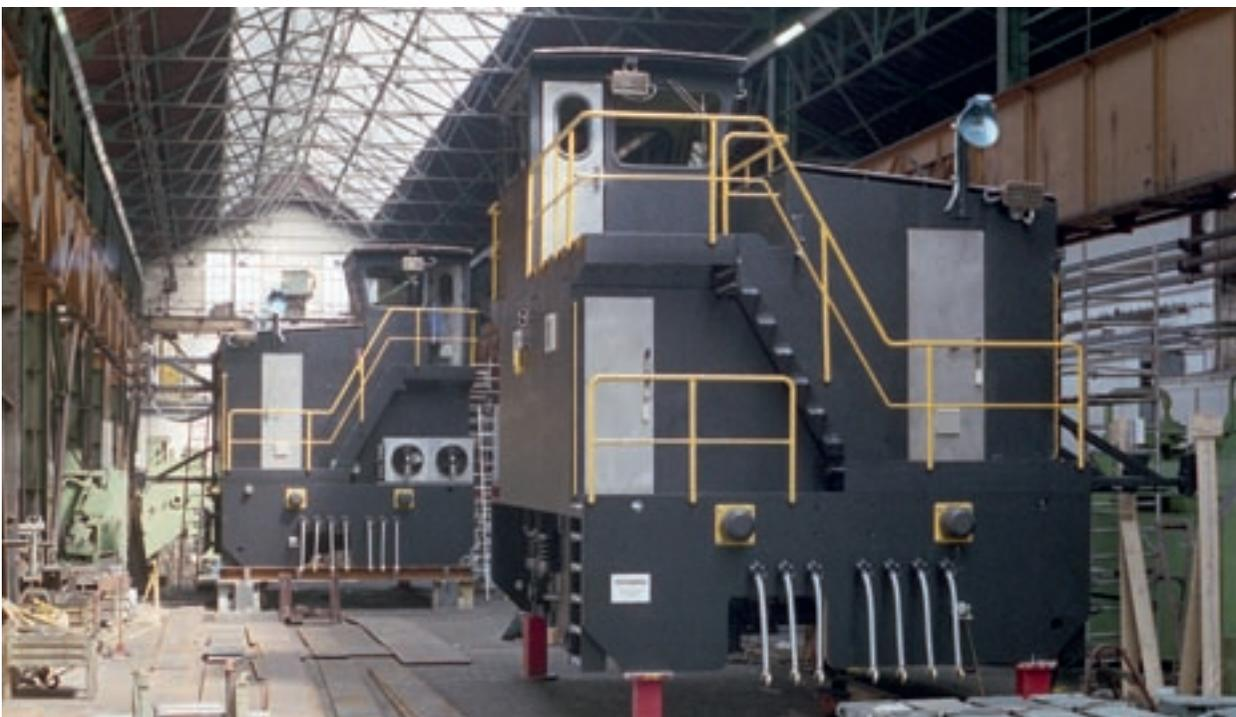
320 Um die schwerer werdenden Löschwagen verschieben zu können, müssen auch die Löschlokomotiven an Leistung und Gewicht zulegen. 1990 sind bei Schalke zwei 50-Tonnen-Loks (Schalke 2.375–2.376) für die Kokerei **Posco** in Kwangyang, Südkorea, in Arbeit.
